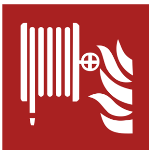
Kennzeichnung eines Löschschlauches durch das Brandschutzzeichen F002
