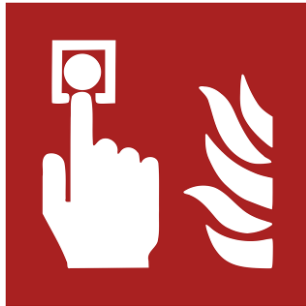
Kennzeichnung eines Handfeuermelders (auch nichtautomatischer Brandmelder) durch das Brandschutzzeichen F005
